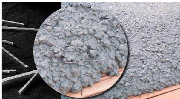
Рис 2. Фибробетонная смесь
