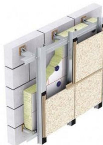
Рис. 7. Облицовка фасада фиброцементной плитой
