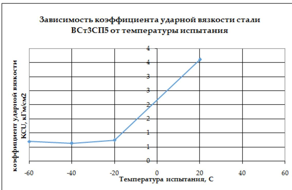
Рис.4 Зависимость ударной вязкости от температуры для материала ВСт3СП
