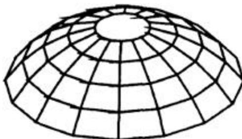
Рис. 2. Схема конструкции ребристо-кольцевого купола
