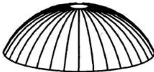
Рис. 1. Схема конструкции ребристого купола
