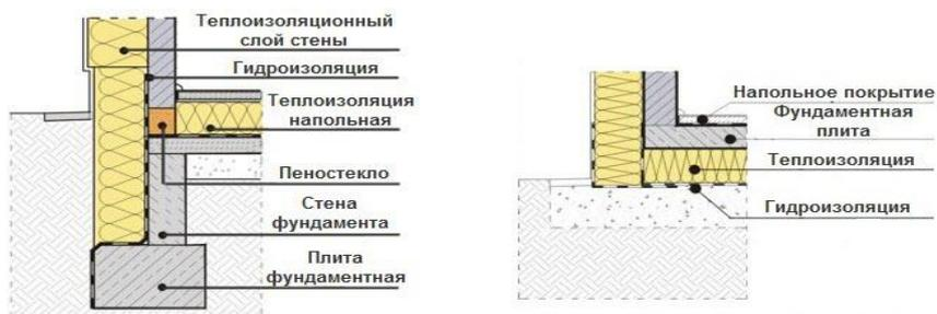
Рис. 1. Теплоизоляция фундамента в «пассивном доме»
