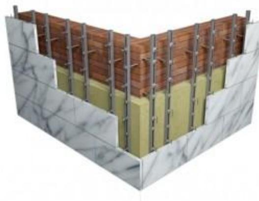
Рис. 1. Состав конструкции вентилируемого
